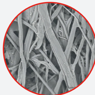
Vista superior del medio de celulosa estandar 260X
